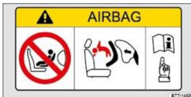
**Abb. 48** Prinzipdarstellung: Airbag-Label an der Sonnenblende.
