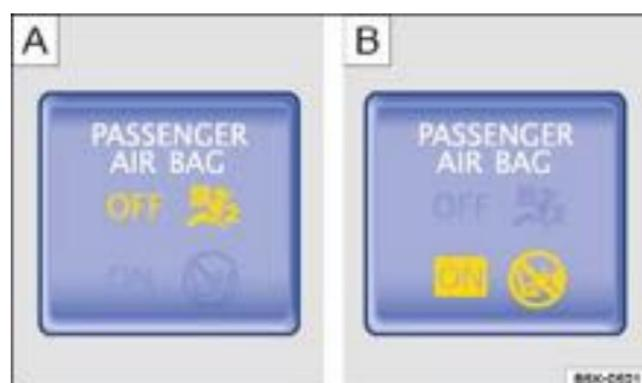
**Abb. 40** In der Mittelkonsole: Kontrollleuchte für abgeschalteten Beifahrer-Frontairbag oder eingeschalteten Beifahrer-Frontairbag .
