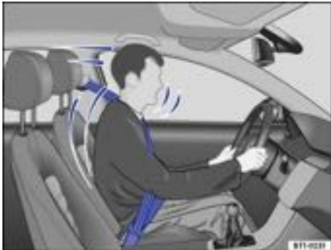
**Abb. 34** Angegurter Fahrer, der bei einem plötzlichen Bremsmanöver vom richtig angelegten Sicherheitsgurt aufgefangen wird.
