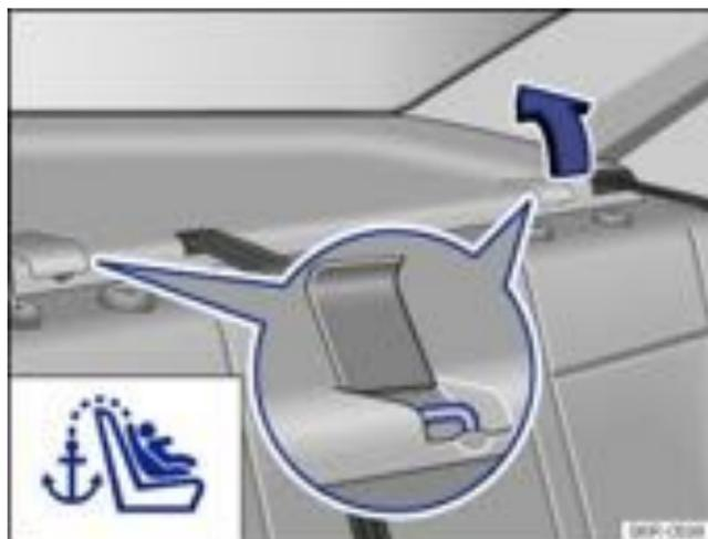
**Abb. 52** In der Ablage hinter den Rücksitzen: Halteösen für Top Tether.
