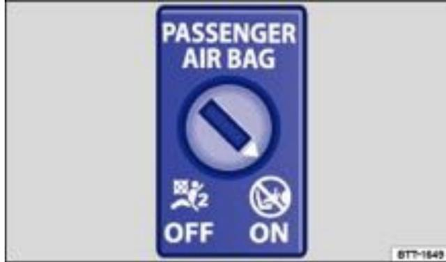
**Abb. 43** In der Instrumententafel auf der Beifahrerseite: Schlüsselschalter zum Ab- und Einschalten des Beifahrer-Frontairbags.
