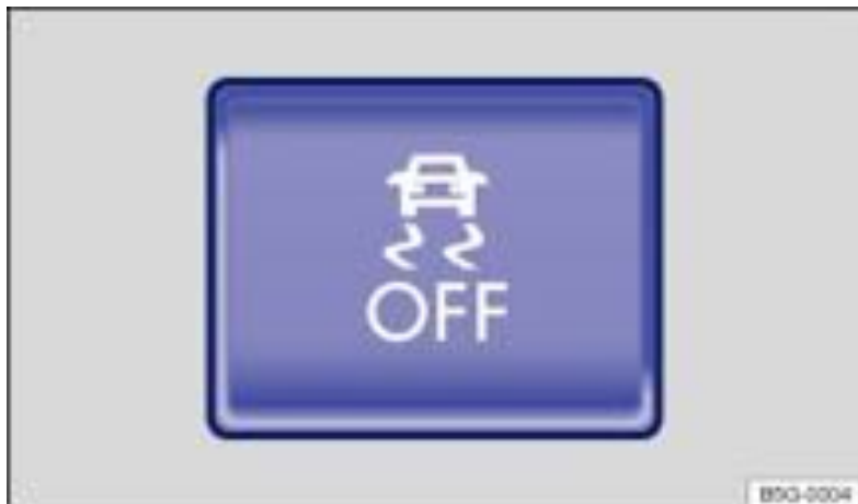
Abb. 128 In der Mittelkonsole: Taste zum manuellen Aus- und Einschalten von ASR bzw. ESC Sport.
